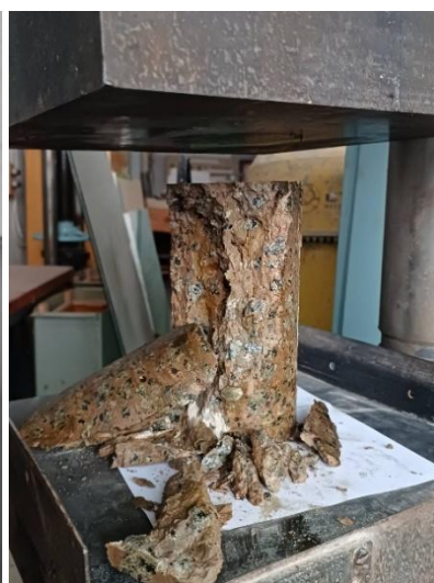
Рис. 3. Зображення зразка бетону №3 (ступінь проникнення олії – 100 %): а – зразок бетону до проведення випробувань; б – зразок бетону просочений олією після руйнації
