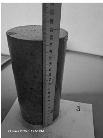
Рис. 3. Зображення зразка бетону №3 (ступінь проникнення олії – 100 %): а – зразок бетону до проведення випробувань; б – зразок бетону просочений олією після руйнації
