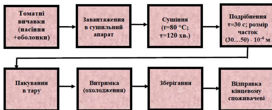
Fig. 5. Flowchart of tomato powder production Рис. 5. Блок-схема отримання томатного порошку
